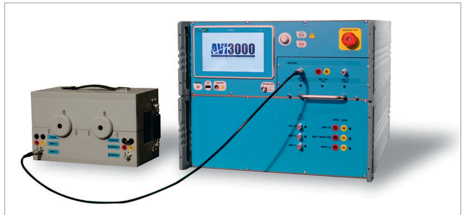
Comme il n'y a plus besoin de changer de pinces d'injection d'un essai à l'autre, le générateur AVI3000 d'EMC Partner, pour les essais aéronautiques, peut être automatisé, ce qui permet de réduire les temps de test.
